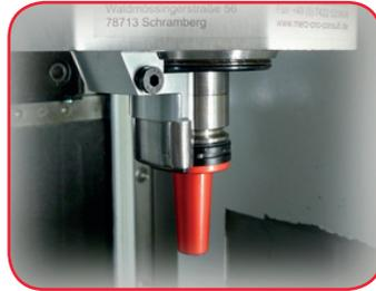
Hält die Schneide Ihres Fräses zuverlässig frei von Spänen, sorgt für eine kontinuierliche Kühlung der Frässtelle und für eine präzise Applikation von Luft und / oder Schmierstoffen
